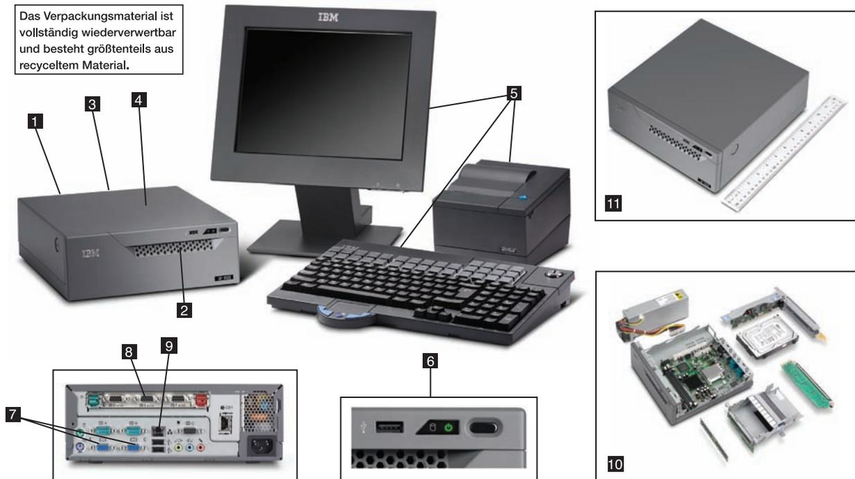
IBM SurePOS 300 System, optional mit kompakter, alphanumerischer POS-Tastatur (CANPOS), IBM SureMark Einstationen-Drucker, IBM SurePoint 12-Zoll-Display
